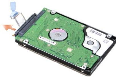
ⓘ **注意:** ハードディスクドライブがコンピュータの外にある間は、保護用静電気防止パッケージに保管します。詳細はコンピュータと同梱の、安全にお使いいただくための注意にある「静電気障害への対処」を参照してください。
